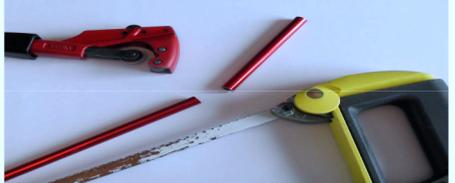
Corte el tubo del largo deseado utilizando una sierra para metales o un corta tubos, lije el extremo.
