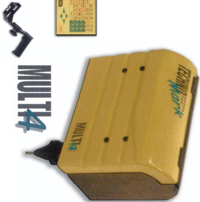
TECHNOMARK está especializado en las técnicas de marcado por micro-impacto magnético. El principio está basado en una deformación del material gracias a una punta vibrante. Esta punta puede hacer un marcado indeleble en todos los materiales aceptando una deformación elástica y con una dureza < 63 HRC (acero tratado o no, inox, aluminio, cobre, aleación, maderas, plásticos, vidrio, etc.).
