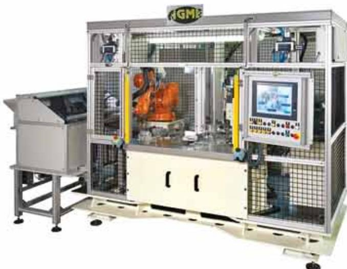
**ENSAMBLAJE DE COMPONENTES DE AIRBAG
